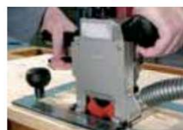
Sichtfenster in Grundplatte
